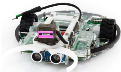
Робоплатформа с набором расширений (клешневой захват и дополнительные датчики).
